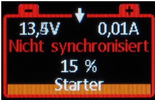
Die Meldung „Nicht synchronisiert“ erscheint, wenn der Shunt SHC neu gestartet und der angezeigte Kapazitätswert noch nicht dem wahren Kapazitätsstand entspricht. Dann muss die an den Shunt SHC angeschlossene Batteriegruppe mit einem Ladegerät vollgeladen werden, damit sich die Kapazitätsanzeige mit der Batterie synchronisieren kann. Die Meldung erlischt dann automatisch.
