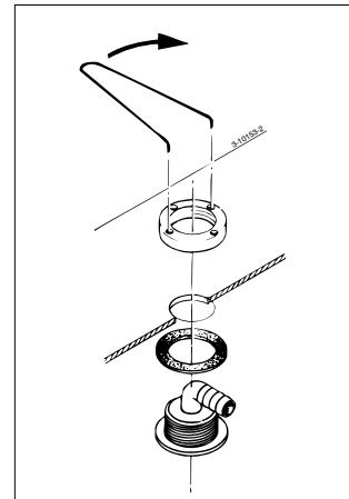
Um Verstopfungen, insbesondere durch Haare und groben Schmutz vorzubeugen, müssen alle Fittingen innen sorgfältig entgratet werden, alle Verengungen auf ein Minimum begrenzt bleiben und Übergänge zu anderen Querschnitten mit konischen Übergangsstücken oder großen Radien ausgeführt werden.
