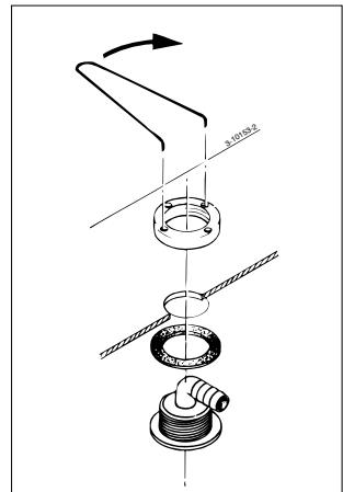
Pour éviter les engorgements dus aux cheveux et saletés, on veillera à ce que l'intérieur des garnitures soit bien ébarbé et on limitera les resserrements à un minimum. Les passages à des diamètres supérieurs seront réalisés par ailleurs au moyen de raccords coniques ou de grands rayons.
