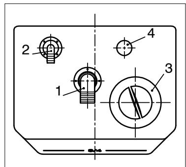
En caso necesario, afloje la tuerca con la llave de tuercas incluida para girar los conectores hacia la dirección requerida. Recuerde luego volver a apretar la tuerca correctamente.
