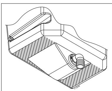
Le réservoir peut par exemple être soutenu à l'aide d'un profilé d'angle.
