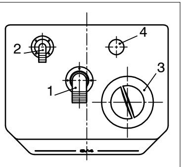
Si nécessaire, dévisser l'écrou avec la clé fournie pour placer les raccords dans la direction désirée. Resserrer ensuite l'écrou à fond.
