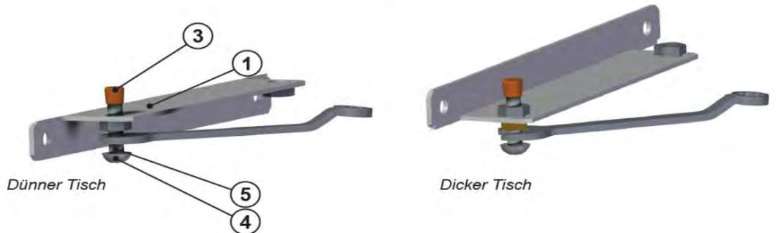
Die Winkelbefestigungen können je nach Stärke der Tischplatte auf zwei Arten montiert werden. Drücken Sie den Abdeckstopfen (3) auf die Schraube. Ziehen Sie die Schraube (4) fest an der Tischplatte an und ziehen Sie anschließend die Sicherungsmutter (5) an.
