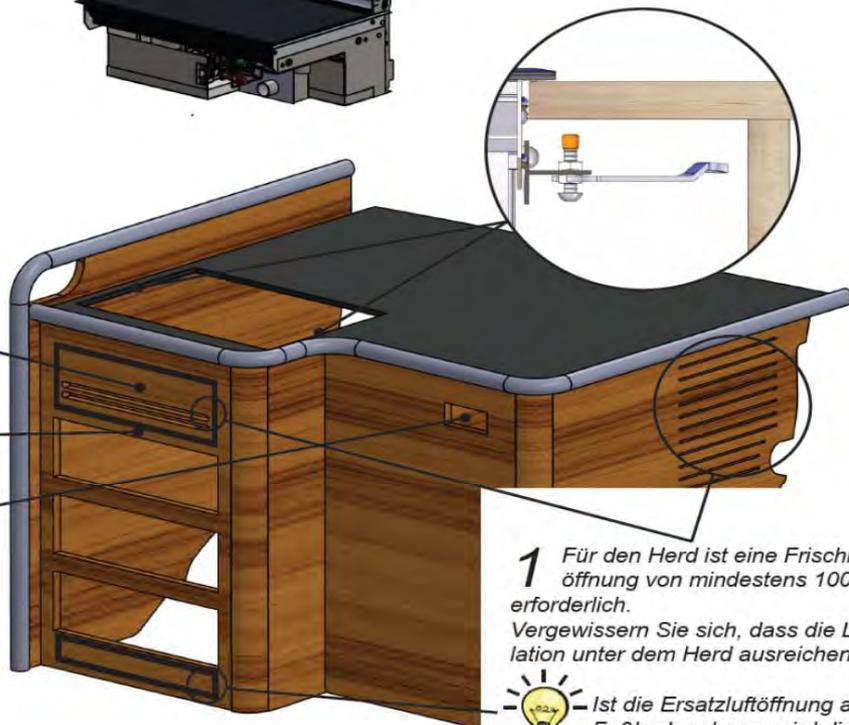
**1** Für den Herd ist eine Frischluftöffnung von mindestens 100 cm<sup>2</sup> erforderlich. Vergewissern Sie sich, dass die Luftzirkulation unter dem Herd ausreichend ist
