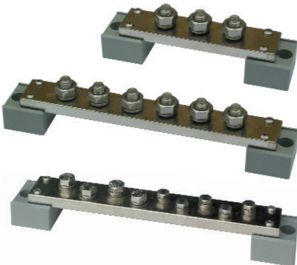
Hochwertige Minuspol-Sammelschienen speziell für große Querschnitte. Geeignet zur Verteilung von Batteriezuleitungen und Kabelabgängen für Ankerwinden, Bugstrahlruder und weiteren Verbrauchern. Der Nennquerschnitt der Schiene beträgt 300 mm<sup>2</sup>. Galvanisch vernickelte Kupferschiene auf Kunststoff-Isolierstützen montiert
