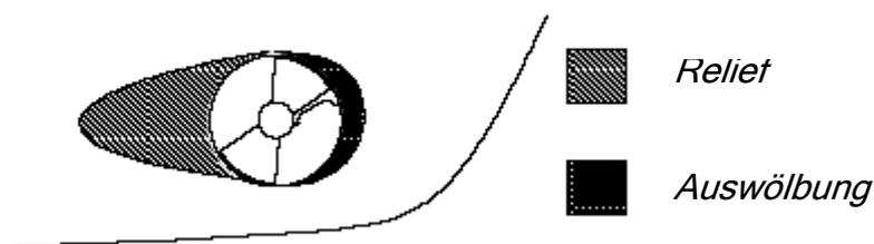
Es werden hierdurch Wasserturbulenzen in der Rohröffnung vermindert. Zur weiteren Strömungsverbesserung könnte für das abfließende Wasser nach hinten eine gewisse Hohleinkerbung (Relief) in den Rumpf erfolgen. Das ist jedoch meist nur möglich, wenn der Einbau bereits mit der Rumpffertigung erfolgt.
