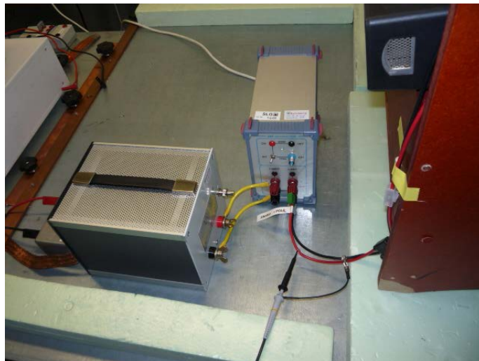
Messung von leitungsgebundenen transienten Störgrößen nach Bild 1b der ISO 7637-2 Measurement of conducted transient disturbances according to figure 1b of ISO 7637-2
