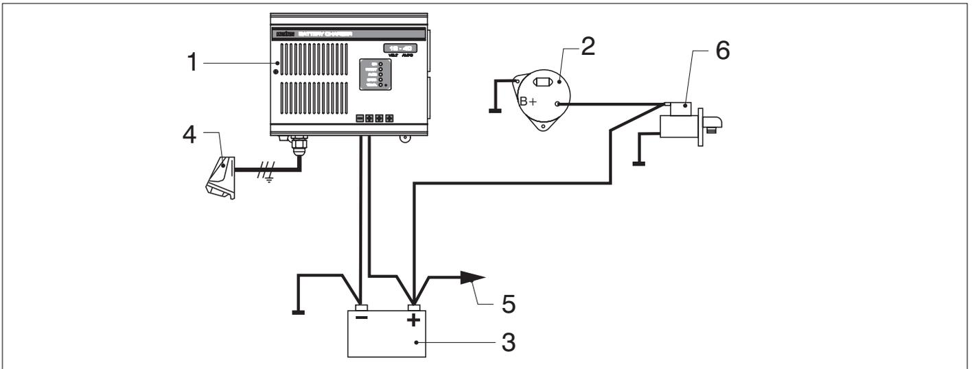
Installatie waarbij de acculader en de dynamo 1 accu opladen.
