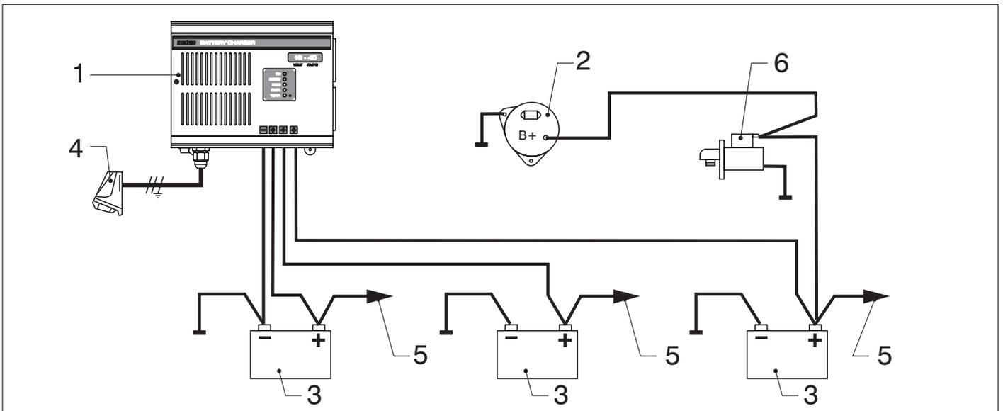
Installatie waarbij de acculader 3 accu's oplaadt en de dynamo 1 accu oplaadt.
