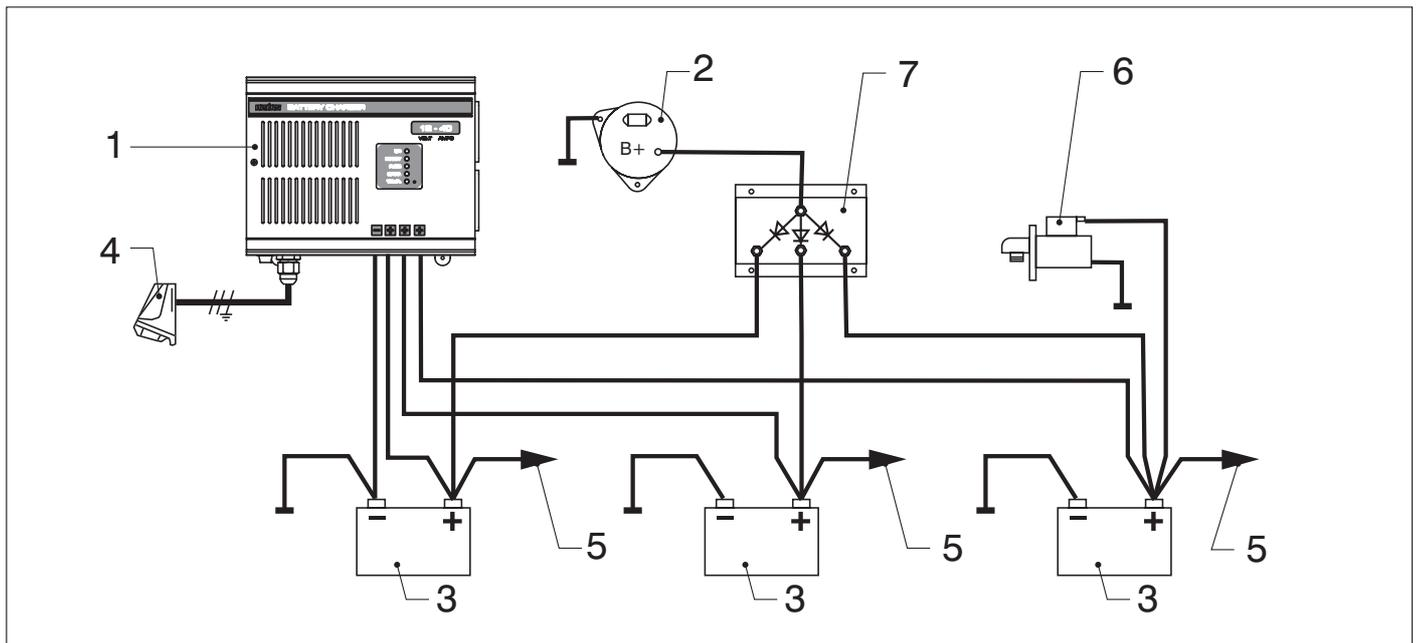
**Installatie waarbij de acculader en de dynamo beide 3 accu's opladen.**
