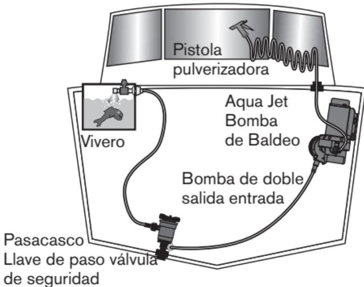
la bomba mediante el adaptador de 1/2" x 3/4" provisto y el conector recto o de 90°. Fije la manguera con las abrazaderas. Para asegurar el mejor rendimiento y confiabilidad, utilice mangüeras lisas grado marino.
