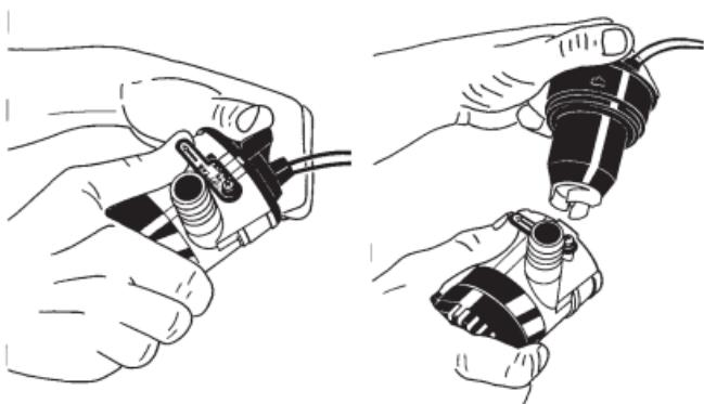
vegetabilisk olja, därefter justera de två kammarna på vardera sida av enheten till de två skårorna i det yttre pumphuset. Pressa ned och vrid vingarna med urs. Prova om enheten har placerats korrekt, genom att vrida vingarna moturs utan att lyfta låshaken. Enheten ska då sitta fast ordentligt.
