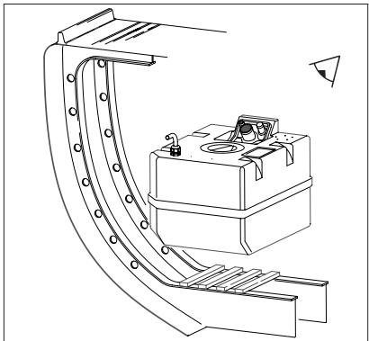
Assicuratevi che il fondamento su cui poggia il serbatoio sia sufficientemente resistente per sostenere e fissare il serbatoio stesso.
