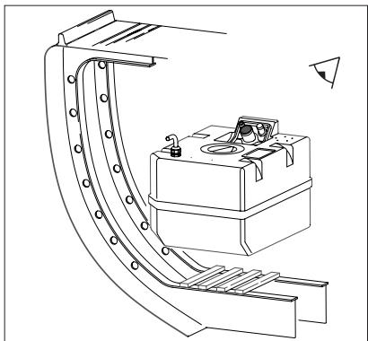
Sorgen Sie für ein ausreichend stabiles Fundament, auf dem der Tank aufgestellt und gut befestigt werden kann.
