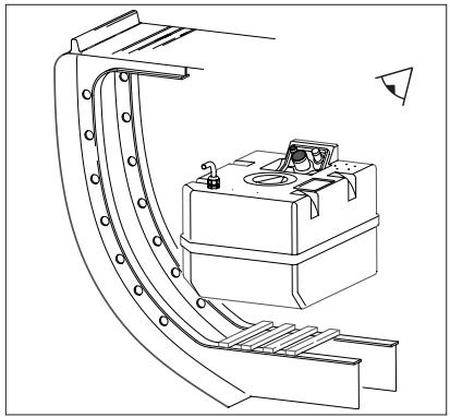
Prévoir un socle suffisamment solide pour installer le réservoir et le fixer correctement.
