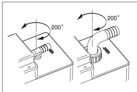
**Monteer de brandstof-overloop** met de reeds voorgemonteerd rubbermof en de meegeleverde slangklem op de vuldop. Gebruik eventueel water of zeep; geen olie.
