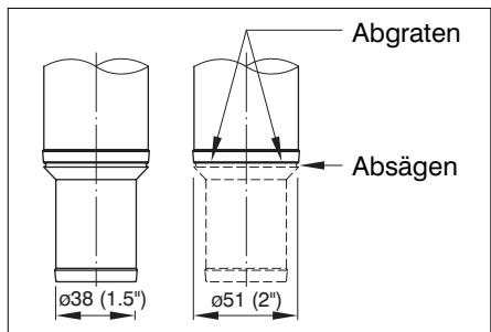
Stellen gut ab und entfernen Sie eventuelle Späne aus dem Treibstoff-Überlauf.
