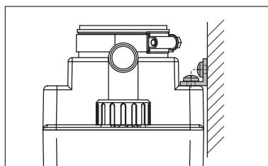
**Monteer een vulslang** tussen de brandstof-overloop en de tank, pas hiervoor een brandstofbestendige slang met een inwendige diameter van 38 mm resp. 51 mm toe. Installeer deze slang zodanig dat zowel de tank als de brandstofoverloop niet mechanisch worden belast.
