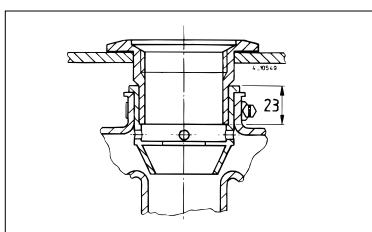
Nella parte superiore, l'interruttore di flusso per carburante è dotato di un raccordo per il condotto di aerazione, con una capacità di rotazione di circa 200°.
