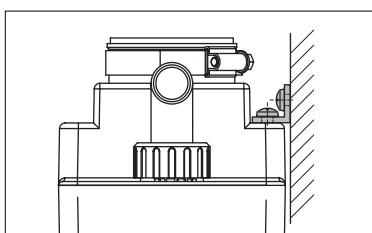
**Montare il tubo** fra l'interruttore di flusso e il serbatoio, a questo scopo utilizzare un tubo resistente al carburante dal diametro interno di 38 mm e 51 mm. Installare il tubo in modo tale che non provochi uno stress meccanico ne' sul serbatoio ne' sull'interruttore di flusso.
