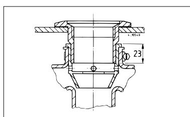
De brandstof-overloop is aan de bovenzijde voorzien van een aansluiting voor de ontluuchtingsleiding. Deze aansluiting is circa 200° draaibaar.
