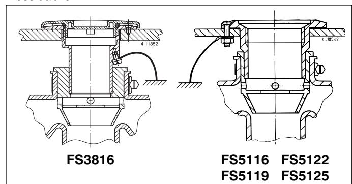
L'elemento di fissaggio di coperta e gli altri componenti che possono entrare in contatto con il carburante, devono essere isolati a terra, per evitare lo svilupparsi di scintille dovute all'elettricità statica. Utilizzare un cavo dal diametro di almeno 1 mm<sup>2</sup>, colore dell'isolante verde/giallo.
