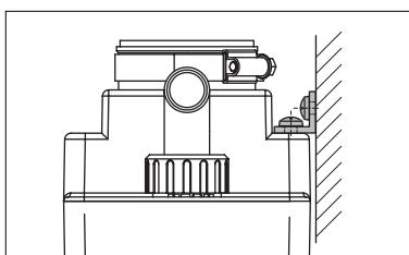
**Monter un tuyau de remplissage** entre le splash stop et le réservoir, utiliser pour cela un tuyau résistant aux carburants ayant un diamètre interne de 38 mm respectivement 51 mm. Installer ce tuyau de façon à ne pas solliciter mécaniquement ni le réservoir ni le splash stop.
