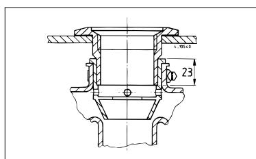
El rebosadero de carburante está provisto en la parte superior de una conexión para el tubo de purgación. Esta conexión se puede girar aproximadamente 200°.
