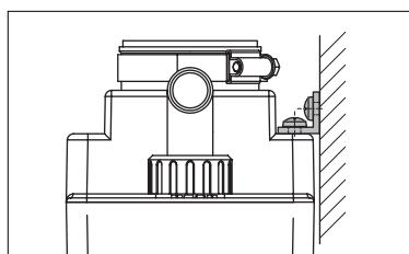
**Montar un tubo de llenado** entre el rebosadero de carburante y el depósito, aplicar para ello un tubo resistente a carburante con un diámetro interno de 38 mm respectivamente 51 mm. Instalar este tubo de forma que no se cargarán mecánicamente el depósito ni el rebosadero de carburante.
