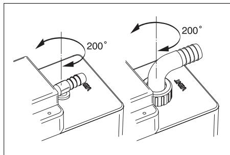
**Montar en el tapón de llenado el rebosadero de carburante** con el manguito de goma ya premontado y la abrazadera de tubo suministrada. Utilizar eventualmente agua o jabón; no aceite.
