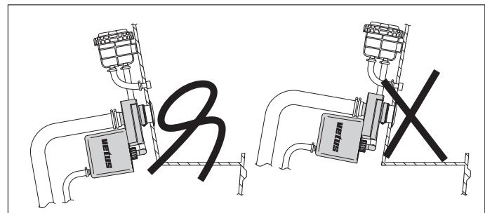
La cloison doit de préférence être inclinée de telle sorte que le tube de remplissage dans le splash stop ait une inclinaison de 10° ou plus.
