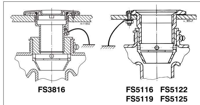
La garniture de pont et les autres pièces métalliques pouvant entrer en contact avec le carburant doivent être mises à la terre pour éviter les étincelles en conséquence de l'électricité statique. Section de fil à utiliser 1 mm<sup>2</sup> au moins, couleur de l'isolation vert/jaune.
