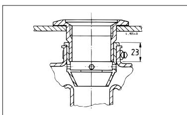
An der Oberseite des Treibstoff-Überlaufs befindet sich ein Anschluß für die Entlüftungsleitung.
