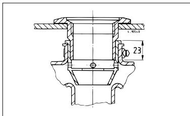
Le splash stop est doté à la partie supérieure d'une connexion pour l'évent. Cette connexion peut tourner d'environ 200°.
