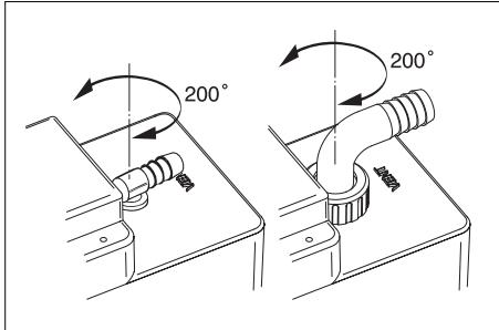
**Monter le splash stop** sur l'entrée avec le manchon en caoutchouc déjà prémonté et le collier de serrage livré avec l'appareil. Utiliser éventuellement de l'eau ou du savon, mais pas d'huile.
