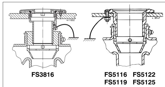
De dekfitting en de andere metalen delen die in aanraking kunnen komen met de brandstof moeten geraard worden om vonken ten gevolge van statische electriciteit te voorkomen. Toe te passen draaddoorsnede tenminste 1 mm<sup>2</sup>, kleur van de isolatie groen/geel.
